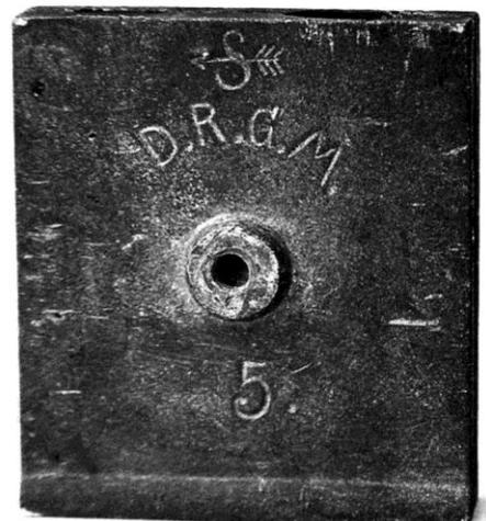
Abb. 9: Typische Kennzeichnung einer Form auf der Außenseite
